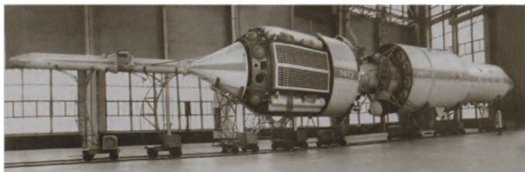
Макет ракетно-космического комплекса «Алмаз» в составе орбитальной пилотируемой станции, транспортного корабля снабжения и возвращаемого аппарата
